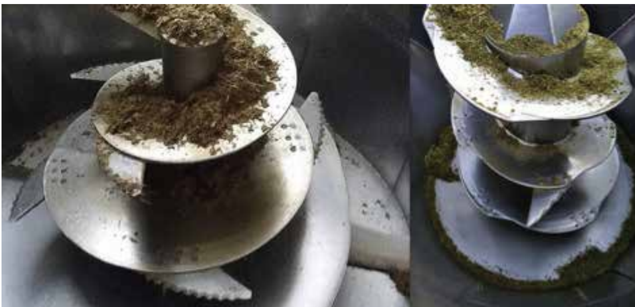
شکل ۵- تیغه‌های تیز در میکسر عمودی (سمت چپ) و تیغه‌های کاملاً فرسوده (سمت راست)
