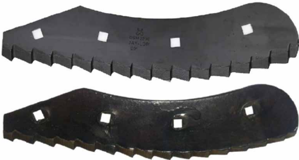
شکل ۱. مقایسه‌ی تیغه‌ی نو و فرسوده‌ی فیدر-میکسر (توجه کنید که شدت سایش دندان‌ها هر چه به نوک آنها نزدیک‌تر می‌شویم بیشتر می‌گردد)
